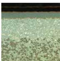
Il grado **YBC103** dispone di una nuova tecnologia di sinterizzazione e può quindi essere utilizzato in una vasta gamma di applicazioni. Grazie al nuovo sistema di rivestimento CVD raggiunge un'elevata resistenza all'usura.
